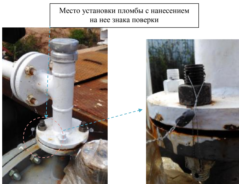
Рисунок 2 – Схема пломбировки от несанкционированного доступа, обозначение мест нанесения знака поверки и пломбы завода-изготовителя
