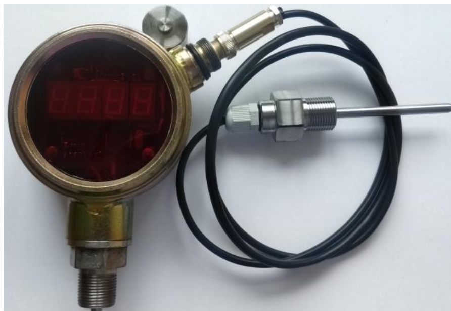
Рисунок 3 - Манометр-термометр устьевой Фотон-И в исполнении с внешним датчиком температуры
