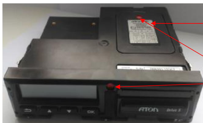
Рисунок 2 – Место размещения знака утверждения типа и схема пломбировки от несанкционированного доступа
