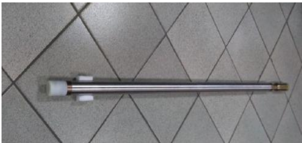
Рисунок 1 – Внешний вид забойной части модуля инклинометрии ЕС.12.01.00.00.000
