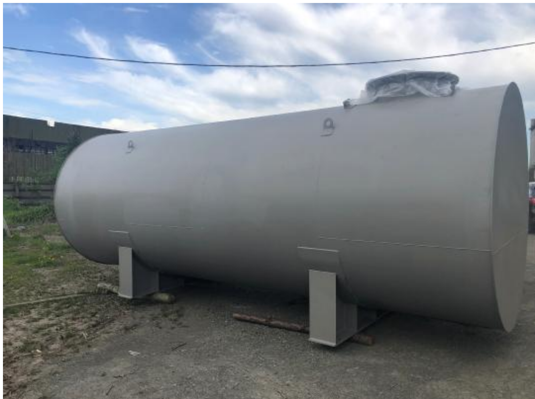
Рисунок 1 – Общий вид резервуара горизонтального стального цилиндрического РГС-25
