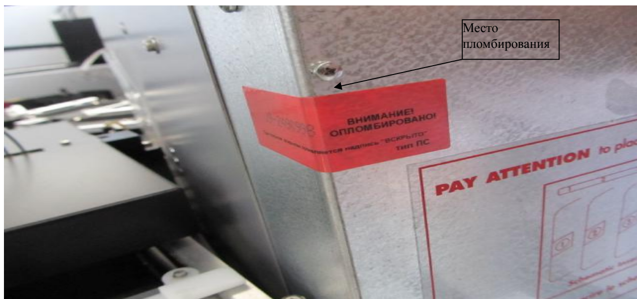
Рисунок 2 – Способ и место пломбирования блока плат системы
