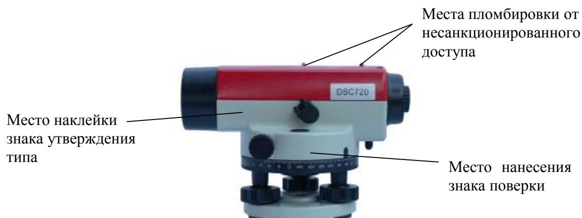
Рисунок 2 - Место пломбировки от несанкционированного доступа, места наклейки знака утверждения типа и знака поверки
