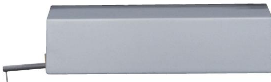
Рисунок 5 – Общий вид гибридного датчика для прибора модификации Surfcom Nex
