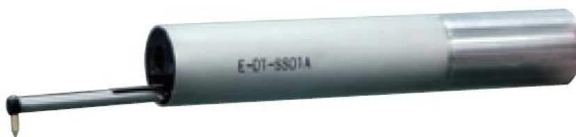
Рисунок 4 – Общий вид датчика для измерений шероховатости поверхности для прибора модификации Surfcom Nex
