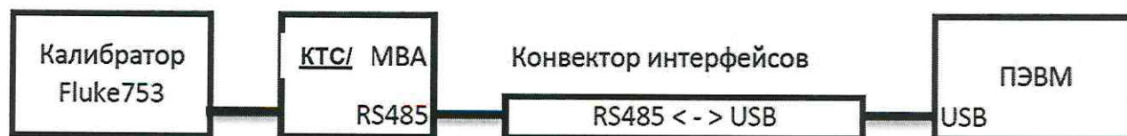
Рисунок 1 - Схема подключения для опробования и подтверждения соответствия программного обеспечения
