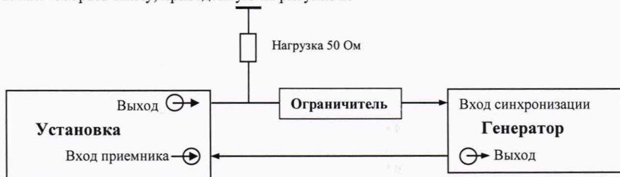
Рисунок 2 – Схема соединения для определения абсолютной погрешности измерений временных интервалов
