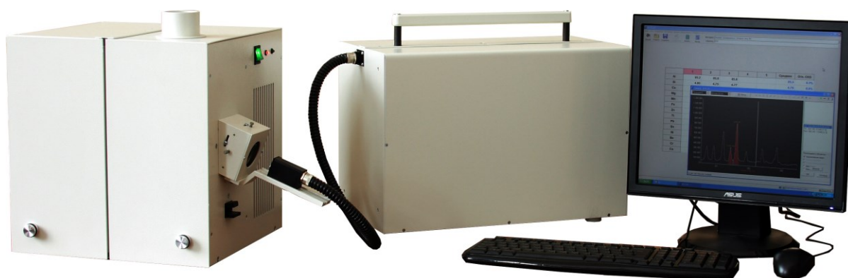
Рисунок 1 – Внешний вид спектрометра эмиссионного «ПАПУАС-4»
