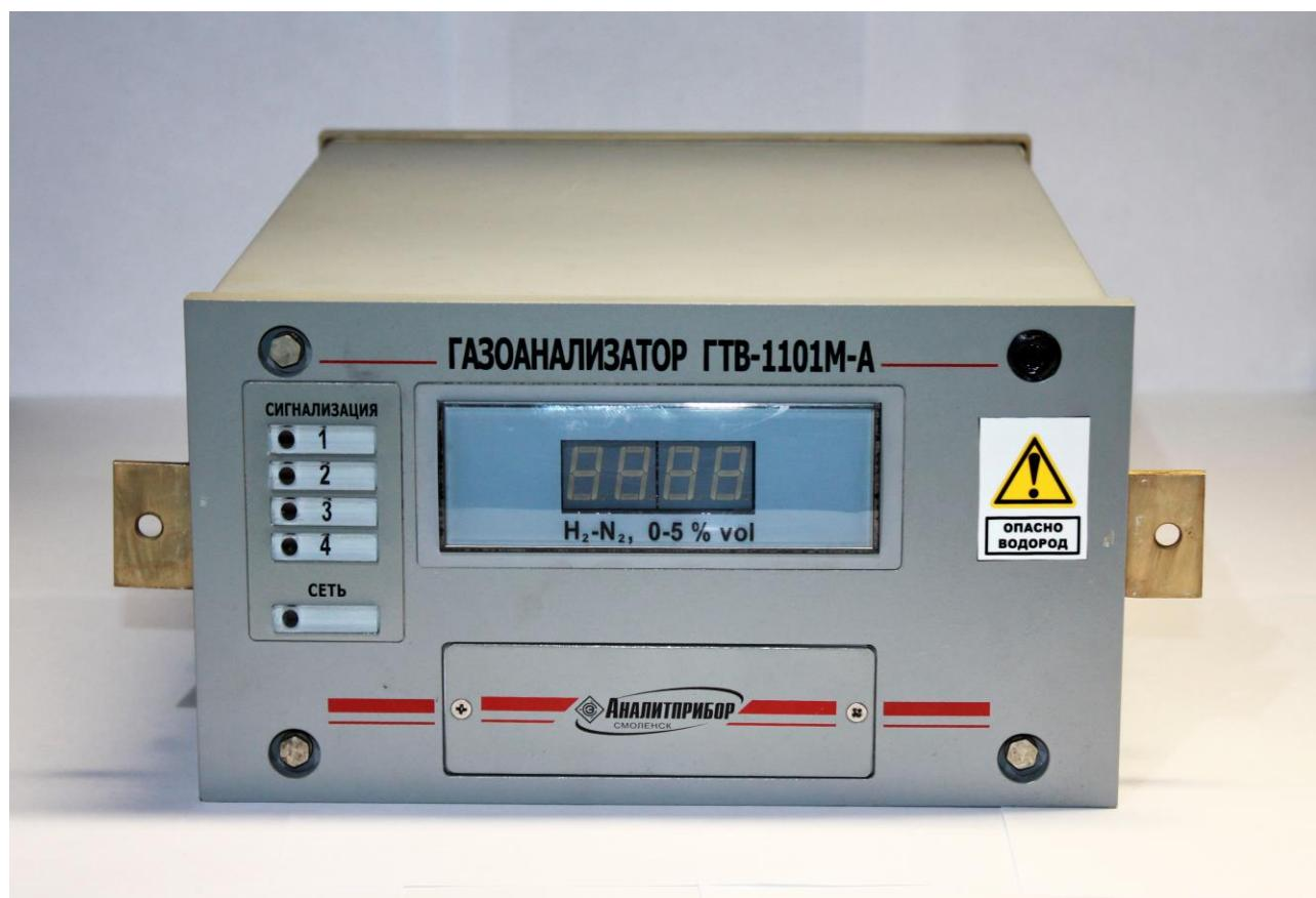
Рисунок 1 - Внешний вид газоанализатора ГТВ-1101М-А.
