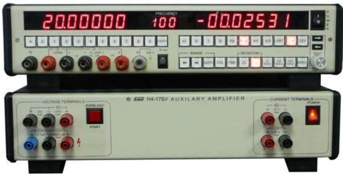
Рисунок 1 – Общий вид калибратора универсального Н4-17
