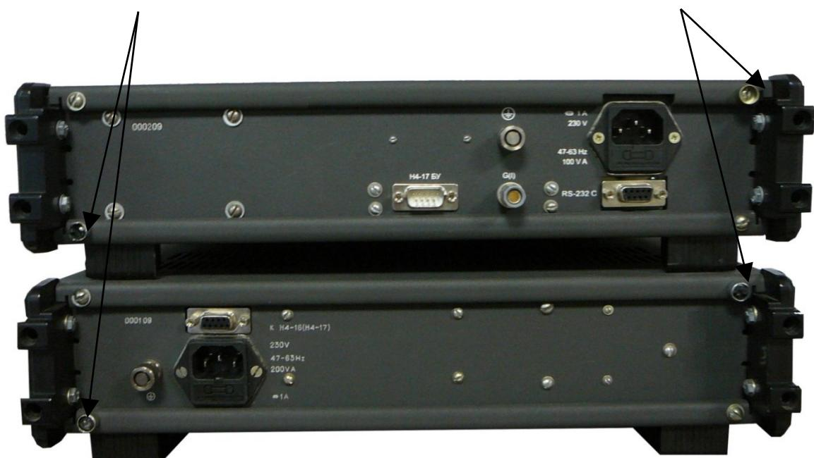
Рисунок 2 – Схема пломбировки калибратора универсального Н4-17 от несанкционированного доступа, обозначение мест нанесения знаков поверки
