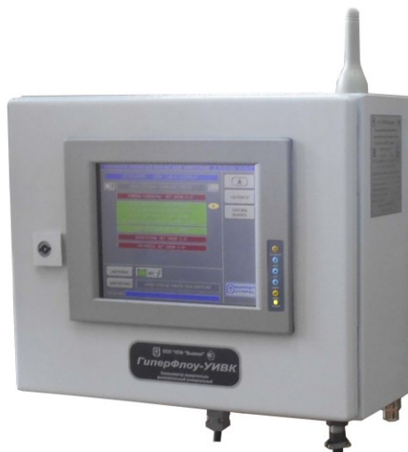
Рисунок 1 – Коммуникатор в металлическом шкафу
