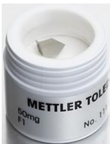
Рисунок 3 – Общий вид гирь в форме многоугольной пластины
