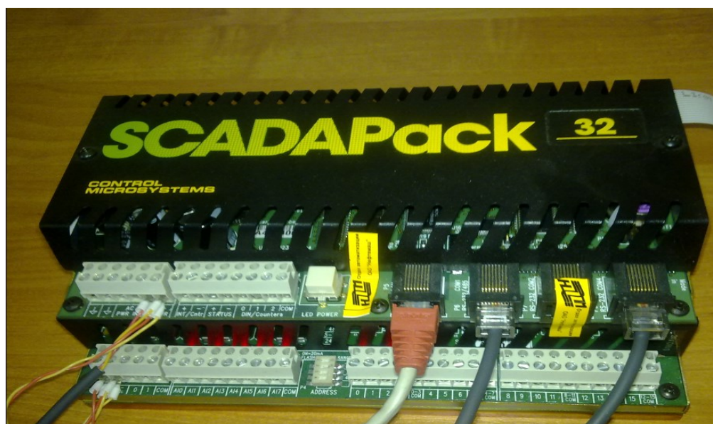
Рисунок 2 – Место пломбировки от несанкционированного доступа контроллера SCADAPack.
