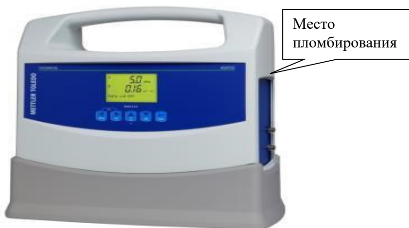
Рисунок 1 –Общий вид лицевой панели анализаторов общего органического углерода 450ТОС
