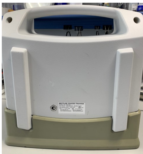
Рисунок 2 – Общий вид задней панели анализаторов общего органического углерода 450TOC
