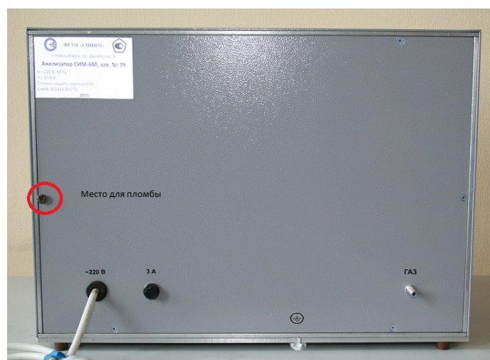
Рисунок 2 - Схема пломбировки от несанкционированного доступа
