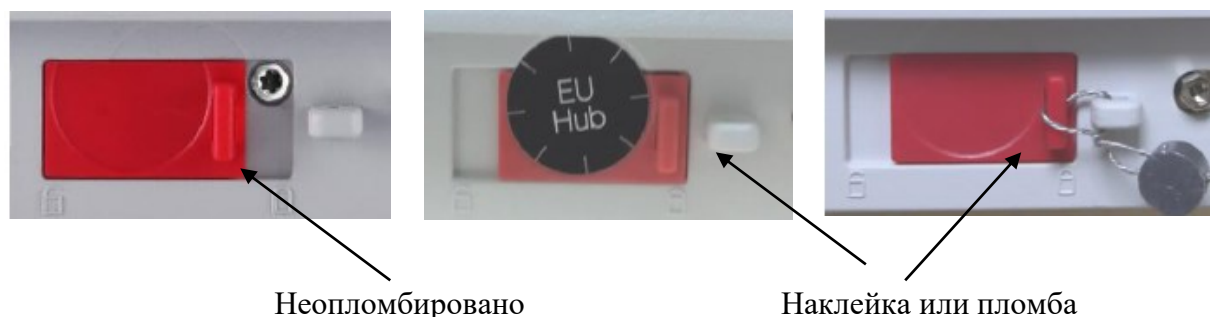
Рисунок 3 - Схема пломбировки от несанкционированного доступа
