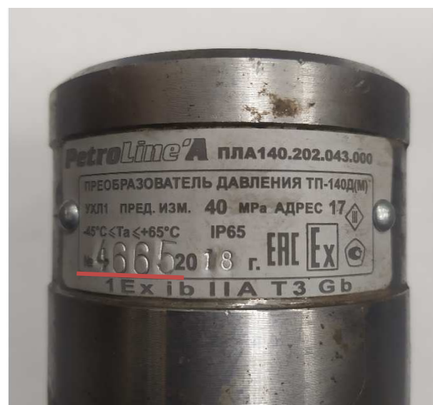
Рисунок 9 – Место нанесения заводского номера преобразователей
