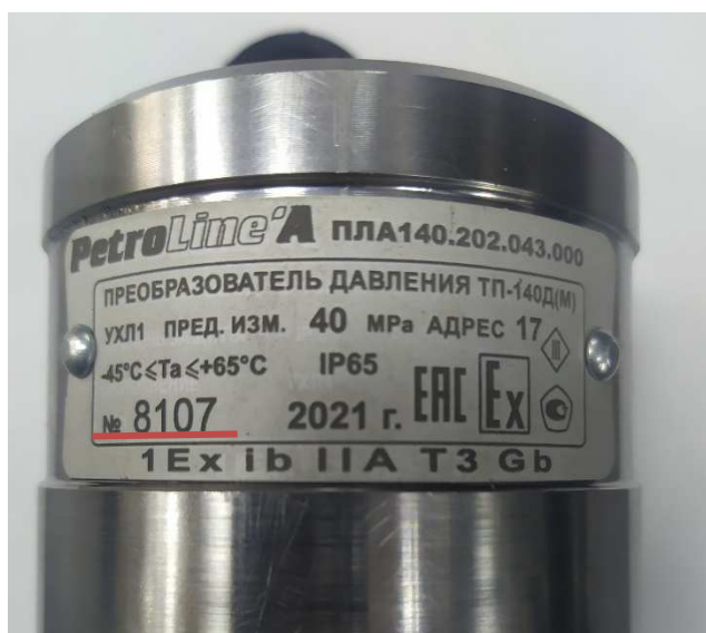
Рисунок 9 – Место нанесения заводского номера преобразователей
