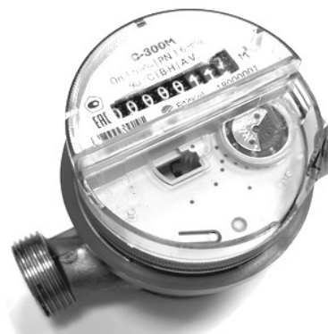
д) счетчики, оснащенные индукционной мишенью, механический счетный механизм которых закрыт прозрачным пластиковым колпаком и скреплен с корпусом защитным пломбировочным кольцом
