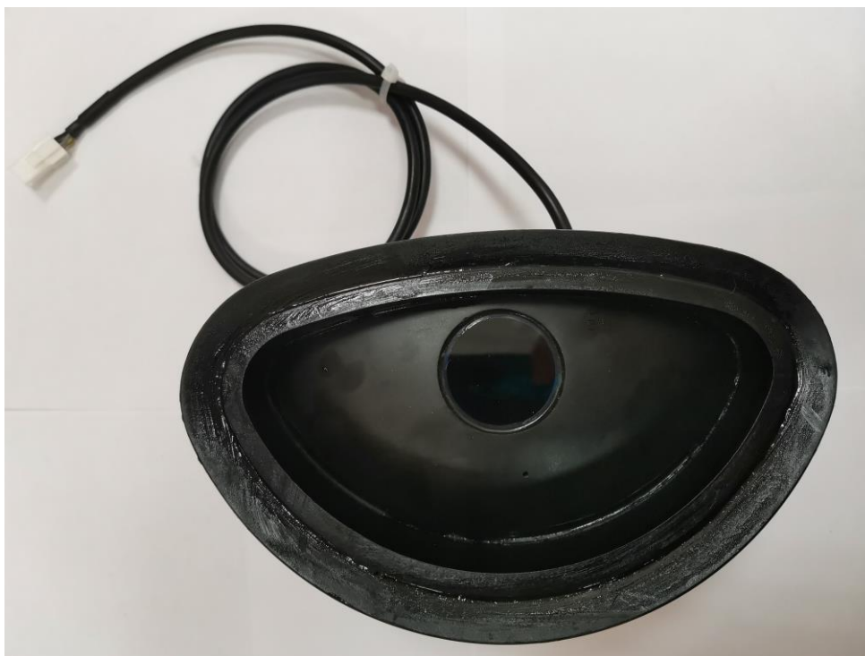
Рисунок 3 – Общий вид блока с устройством для крепления на стекло транспортного средства Знак утверждения типа не наносится.
