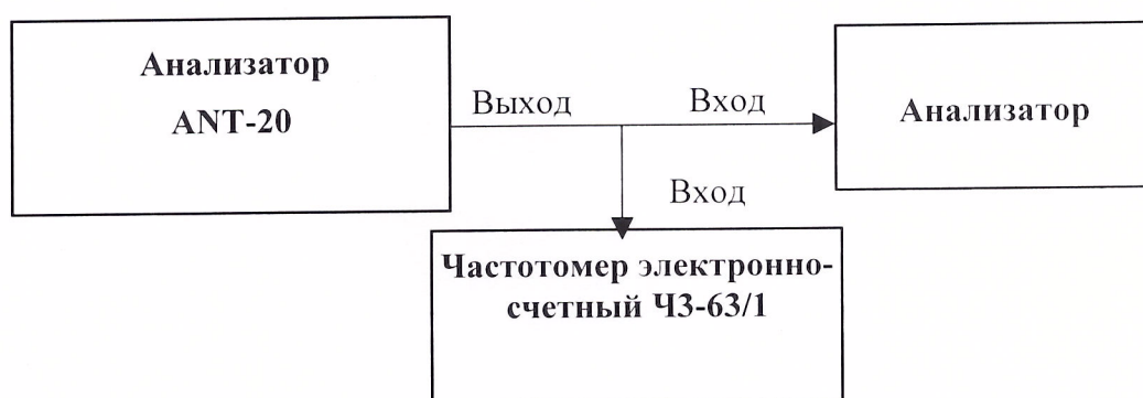
Рис.11. Измерение устойчивости анализатора к расстройке тактовой частоты входного сигнала.
