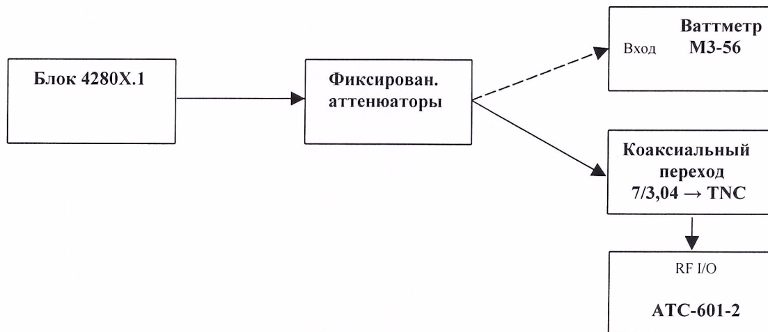
Рис. 4. Схема проверки погрешности измерений импульсной мощности сигналов ответа
