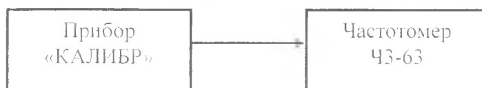
Рисунок 35 - Структурная схема соединения приборов при измерении частоты сигнала калибратора
