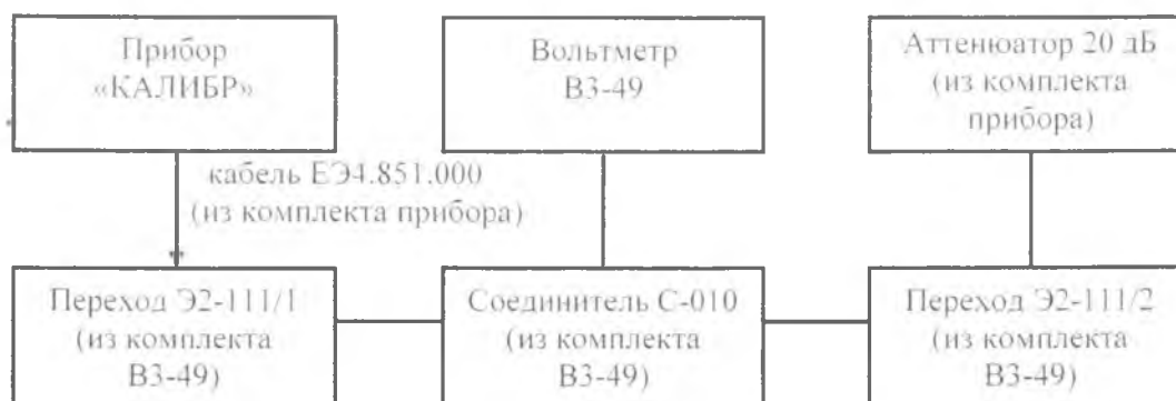
Рисунок 36 - Структурная схема соединения приборов при измерении напряжения сигнала калибратора.
