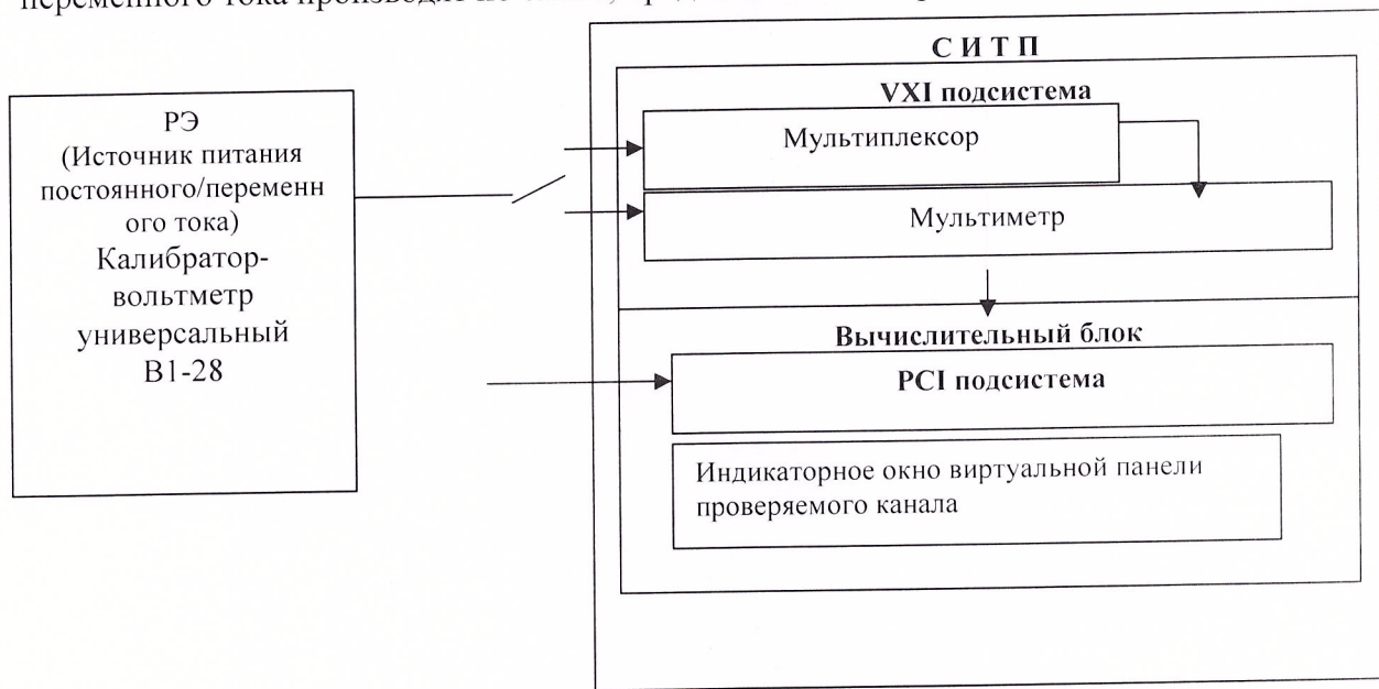
Рис.11.1 Схема включения приборов при определении погрешности измерительных каналов напряжения постоянного и переменного тока VХI подсистемы СИТП
