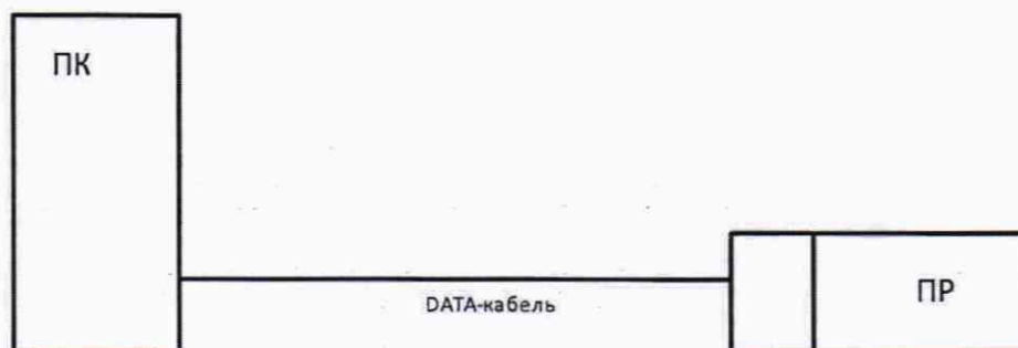
Рисунок А.5 - Схема включения преобразователей с выходным цифровым сигналом протокола Modbus RTU при определении основной погрешности и вариации
