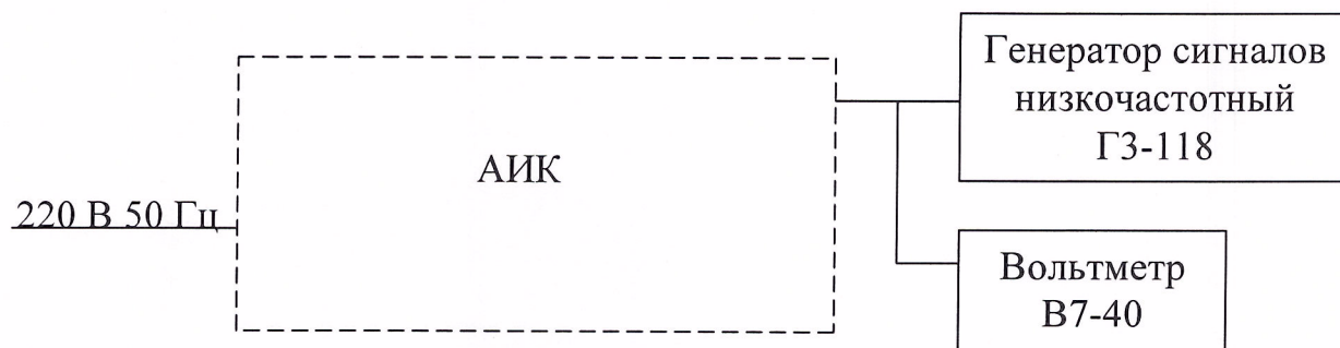
Рисунок 14 – Схема подключения для измерения напряжения частоты 1000 Гц
