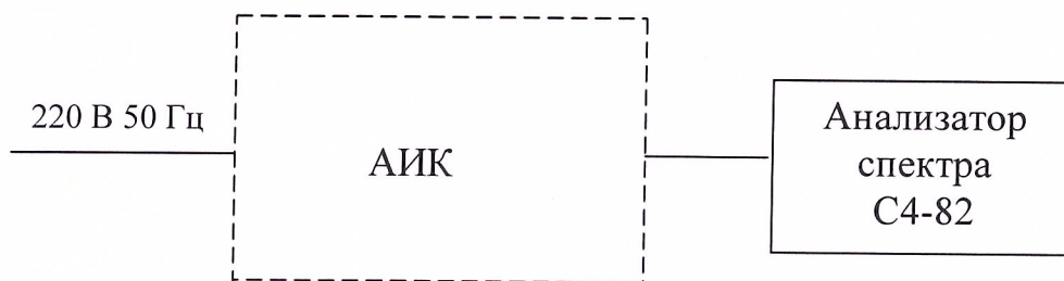
Рисунок 12 – Схема подключения для измерения уровня в.ч. сигнала
