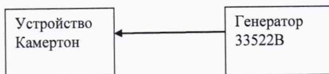
Рисунок 8 Проверка диапазона и относительной погрешности измерения частоты входных сигналов
