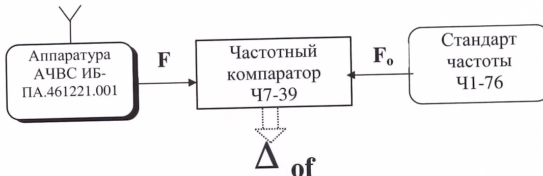
Рис. 2. Схема определения относительной погрешности по частоте.
