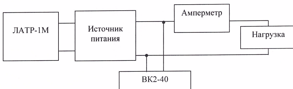
Рис. 3. Структурная схема соединения приборов при определении нестабильности выходного напряжения.
