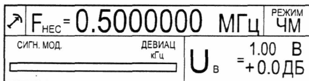
Рис 7. Вид индикатора генератора в режиме частотно-модулированных колебаний от внешнего генератора.
