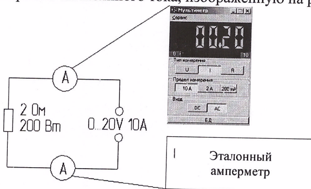
Рис. 4. Схема измерения силы тока
