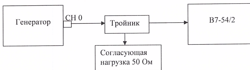
Рисунок 5 - Структурная схема соединения приборов при определении погрешности воспроизведения размаха амплитуды выходного синусоидального сигнала
