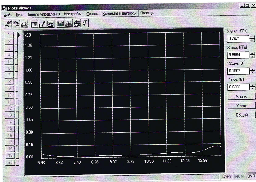
Рис. 3 Пример СКО относительной случайной составляющей погрешности измерений амплитудного распределения
