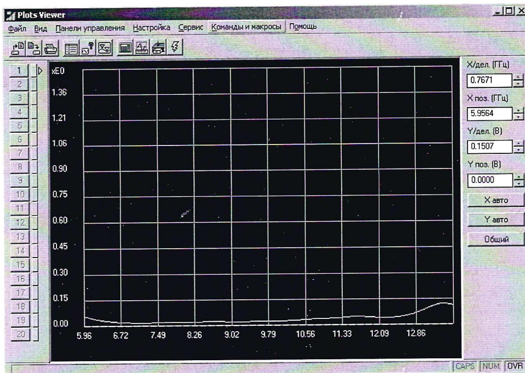
Рис. 3 Пример СКО относительной случайной погрешности измерений амплитудного распределения
