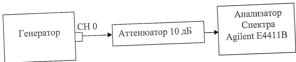
Рисунок 6.6 - Структурная схема соединения приборов при определении относительного уровня гармонических составляющих по основному тракту с высоким усилением
