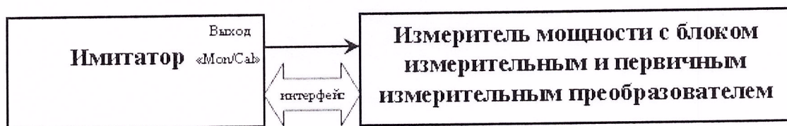
Рисунок 3 – Схема измерений для определения номинального уровня мощности выходных сигналов
