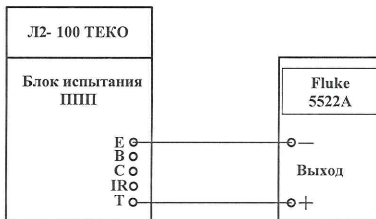
Рисунок 4. Схема измерения тока коллектора.
