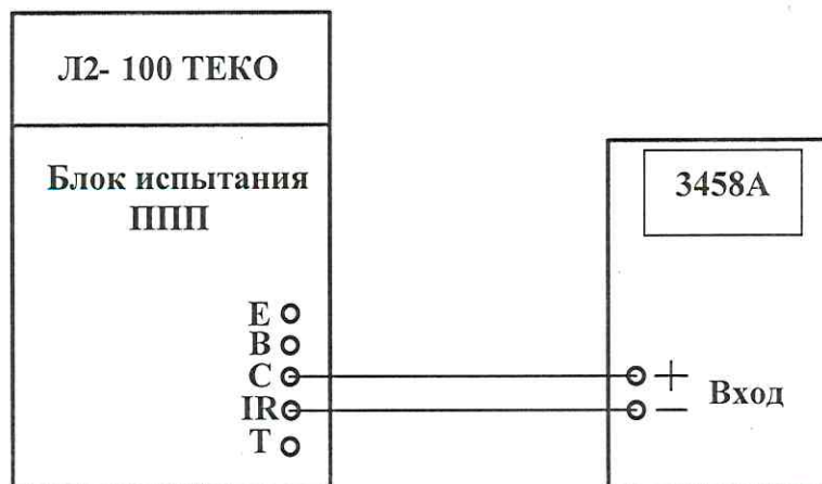
Рисунок 5. Схема измерения начального и обратного тока
