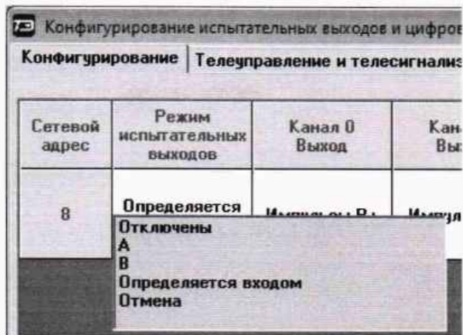
Рисунок 5 - Конфигурирование основного (А) и поверочного (В) режима телеметрии
