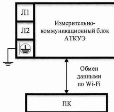
Рисунок 4 – Структурная схема для подтверждения программного обеспечения АТКУЭ
