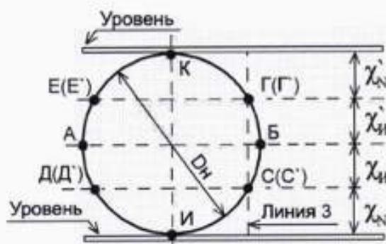
Рисунок 10.2.9 – Разметка трубопровода при врезке по нижней и верхней хордам
