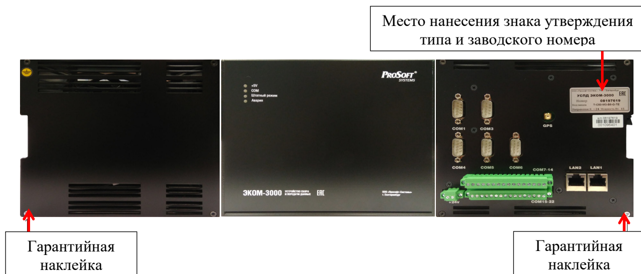
Рисунок 1 – Общий вид с указанием места нанесения знака утверждения типа и заводского номера, а также схема пломбирования от несанкционированного доступа УСПД
