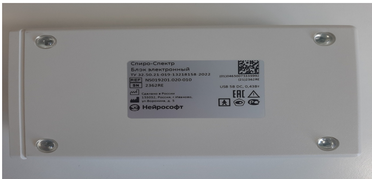
Рисунок 3 - Место, способ и формат нанесения заводских номеров, знака утверждения типа и кода DataMatrix
