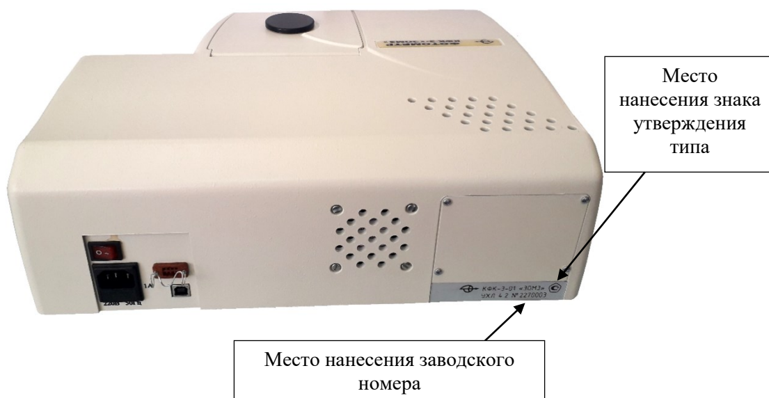
Рисунок 2 – Обозначение места нанесения заводского номера и знака утверждения типа
