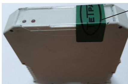
Рисунок 10 – Схема пломбировки от несанкционированного доступа
