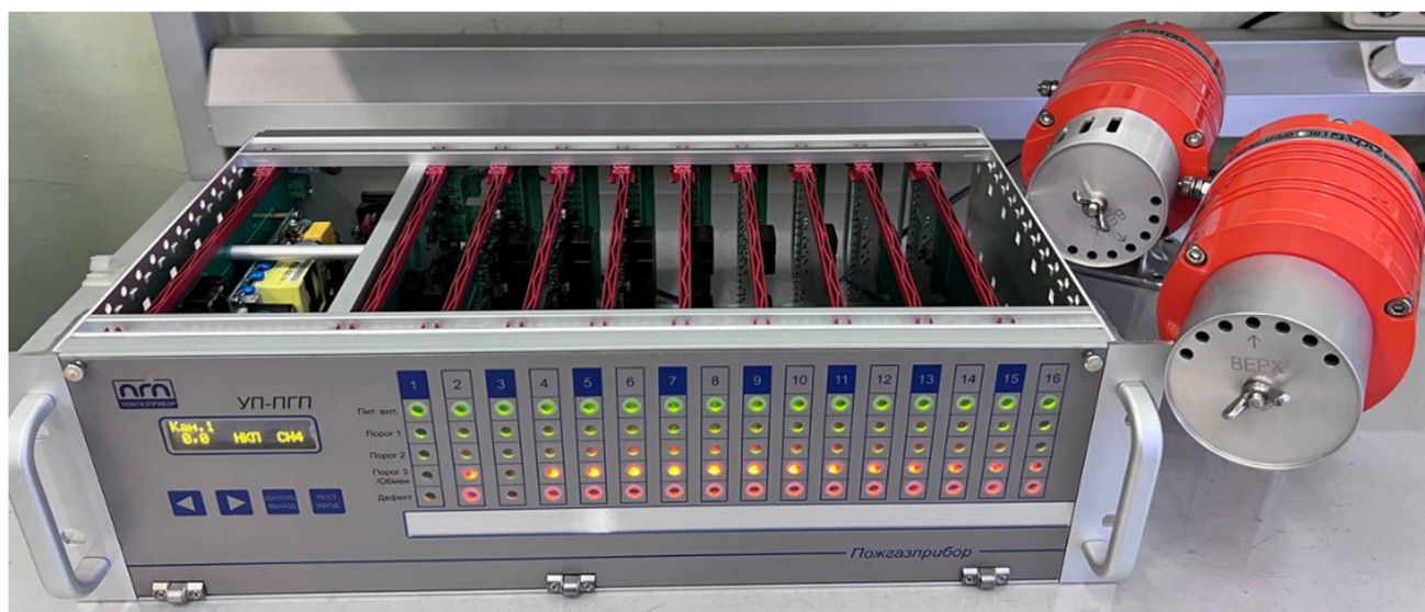
Рисунок 2 – Общий вид газоанализаторов СГС-ПГП в составе с газоанализатором ОГС-ПГП и устройством пороговым УП-ПГП
