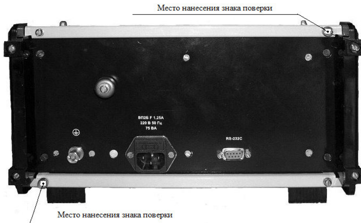
Рисунок 2 - Схема пломбировки от несанкционированного доступа, обозначение мест нанесения знака поверки
