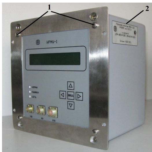
Рисунок 3. ЭП типа ЭРМ-600. Общий вид ЭП с указанием мест пломбировки и нанесения наклеек
