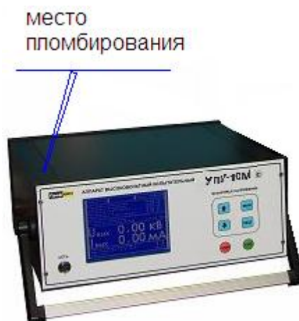
Рисунок 1 - Общий вид установок высоковольтных измерительных «ПрофКиП УПУ-10М»
